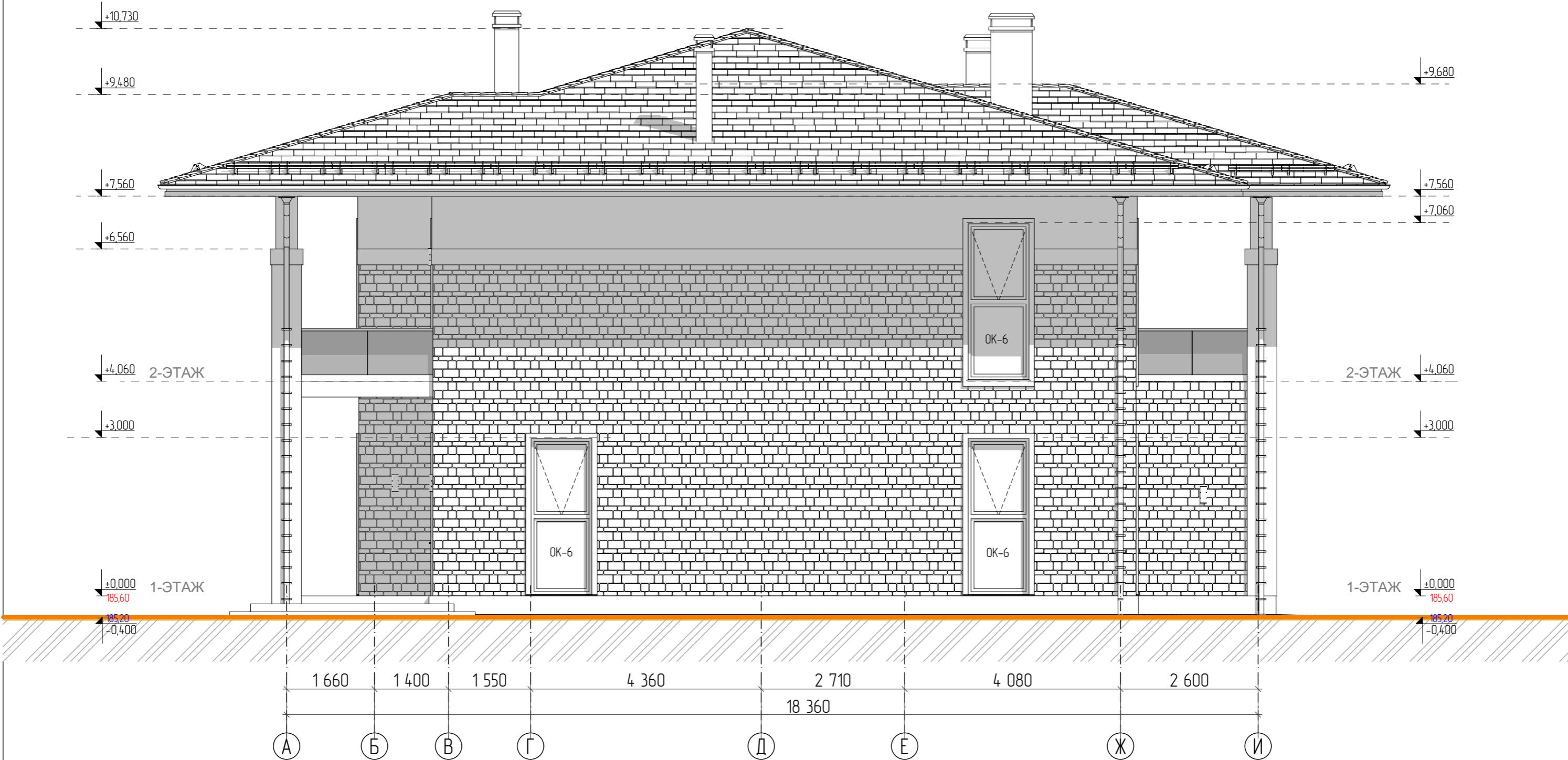
За условный ноль принято отметка в уровне чистого пола первого этажа равная 185,6 м Балтийской системы высот.
