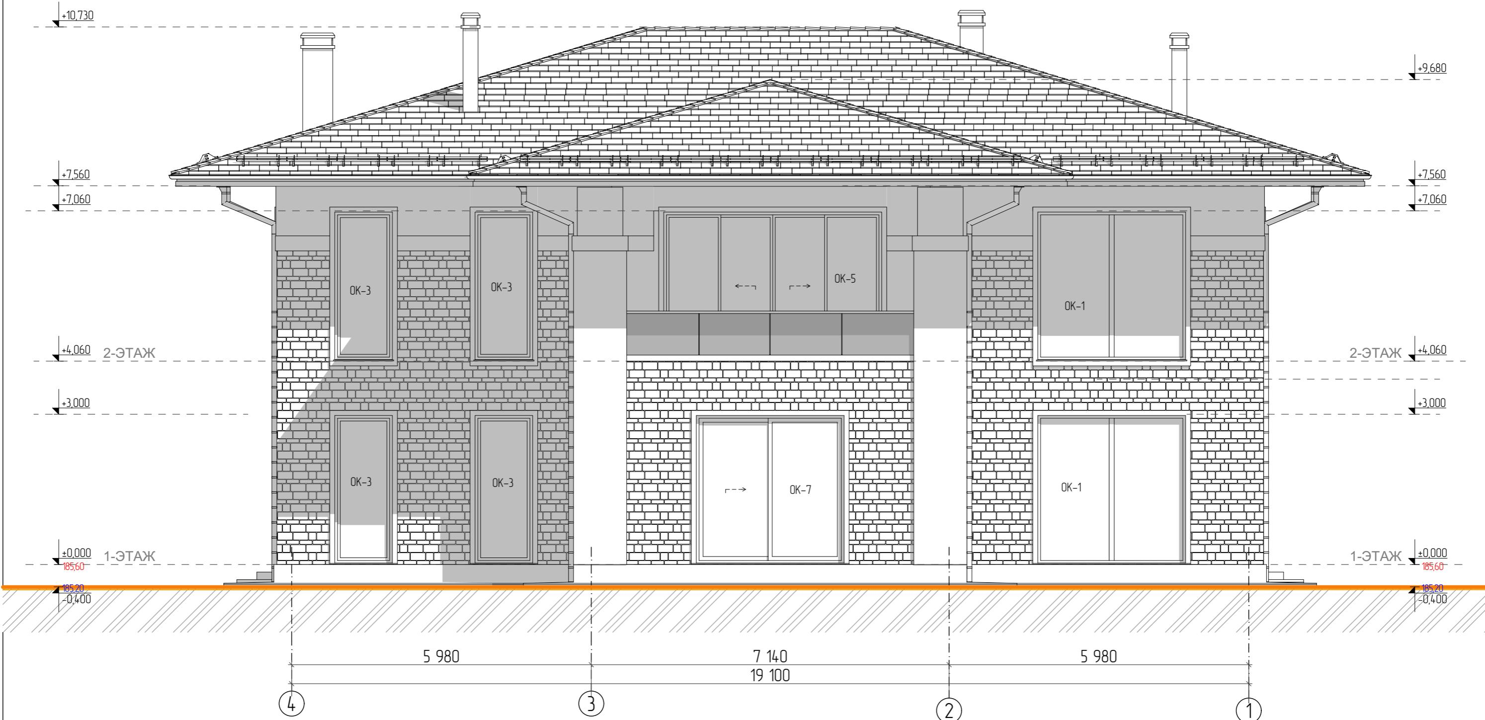
За условный ноль принята отметка в уровне чистого пола первого этажа равная 185,6 м Балтийской системы высот.
